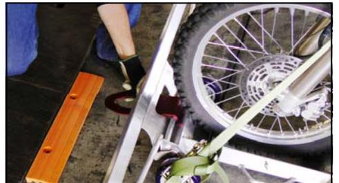
8.) ATTACH CARRIER'S WINCH CABLE HOOK TO MOTORCYCLE HOOK ADAPTOR. NOTICE THAT ALL CABLE FORCE IS NOW ON THE DOLLY.
